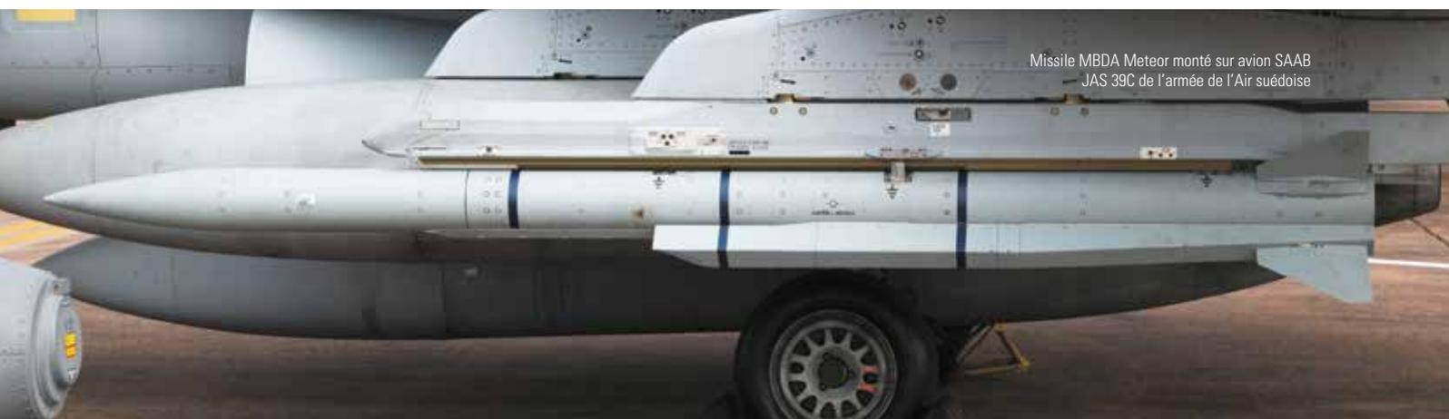
Missile MBDA Meteor monté sur avion SAAB JAS 39C de l'armée de l'Air suédoise
